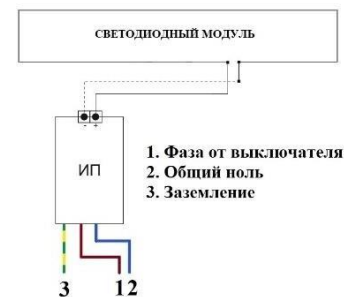
Схема подключения светильника
